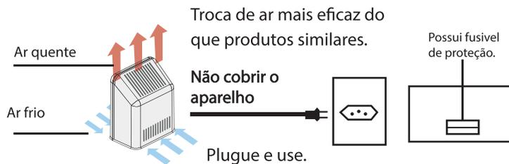
Um LED frontal acenderá quando o esterilizador for ligado na tomada. Após alguns minutos ligado, ocorrerá o aumento de temperatura interna do bloco resultando na esterilização do ar.
