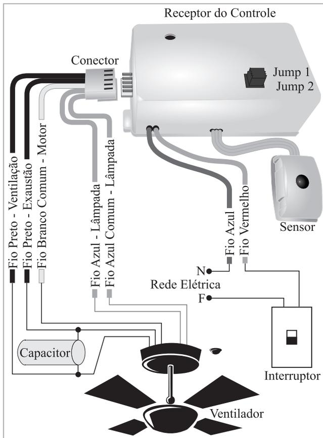
O RECEPTOR DO CONTROLE deve ser instalado na canopla (componente utilizado para dar acabamento final junto ao teto) do seu ventilador.
