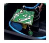
**3 Fusível:** Para proteção de sobrecarga o Filtro utiliza um porta fusível com o fusível de 10A ação rápida.
